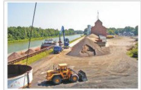
Mit leistungsstarken Umschlagsgeräten werden Baustoffe wie Kies, Sand, Natursteinsplitle und Lava sowie Roheisen, Stahlschrott und Dünger verladen.
