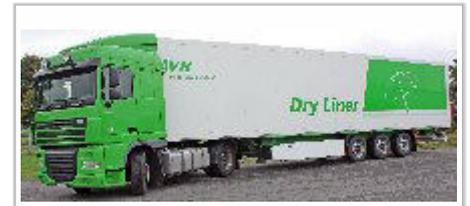
Der Dryliner eignet sich für alle Trockenfrachten! Dank des Doppelstocks transportiert der Kofferauflieger bis zu 66 Paletten. Eine weitere Besonderheit: Das Fahrzeug ist beheizbar, sodass die Ware unter perfekten Bedingungen über die Straßen gebracht wird.
